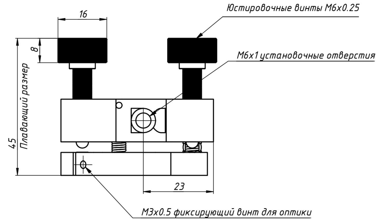
Средний держатель оптики MMM-25.4-k наиболее часто используется для установки и юстировки оптических элементов во всём многообразии оптических устройств. Позволяет устанавливать оптику диаметром 25.0 - 25.4 мм.
